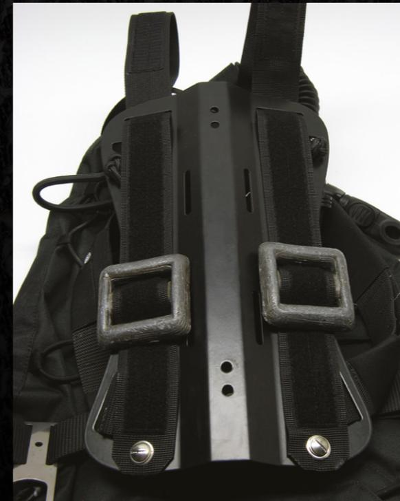
Il posizionamento dei piombi sulla cinghia aumenta la distanza tra la piastra interna e quella esterna, pertanto è necessaria una regolazione delle viti centrali. Viti di diverse lunghezze (M8x40, M8x50, M8x60, M8x70) sono incluse come accessori per consentire un adattamento ottimale.
